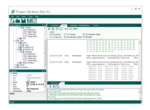
Esta herramienta permite hacer el seguimiento del intercambio de tramas de información entre los dispositivos, con el propósito de hacer un diagnóstico del estado de las comunicaciones de manera fácil y sencilla, debido al tratamiento realizado sobre las tramas de comunicación, las cuales son descompuestas y analizadas, haciendo uso de filtros para mejorar su legibilidad.
